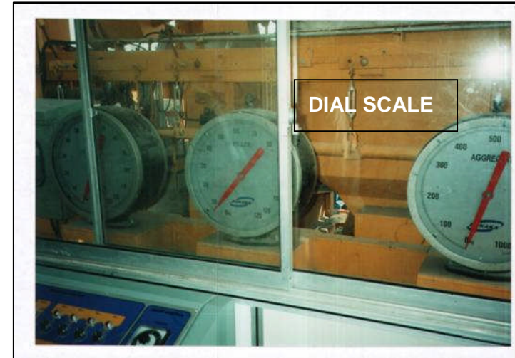
Gambar 3. alat timbangan (dial scale) asbuton butir (filler)
