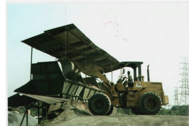
Gambar 11. Penyiapan Agregat ke dalam Cold Bin memakai wheel loader
