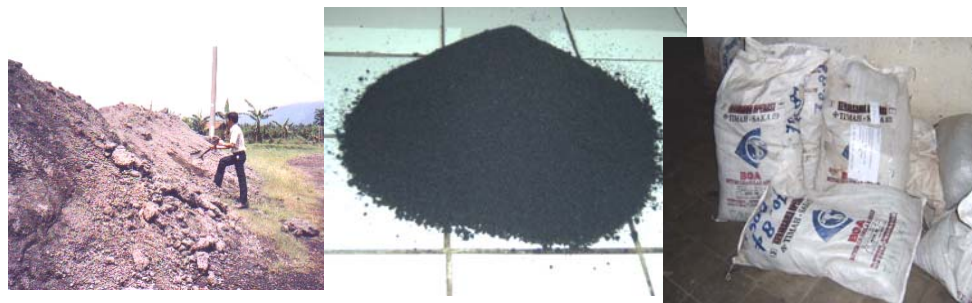
a) Asbuton konvensional (curah) b) Asbuton butir dengan ukuran butiran 1,16 mm
